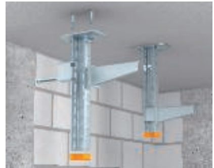
Függesztett oszlop és oszlopkonzol szerelése, aszimmetrikus elrendezés A függesztett oszlop szerelése oszlopkonzollal. 400 mm tálcaszélességtől a DSK közdarab beépítése is szükséges.
