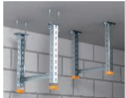
Egyedi tartószerkezet Egyedi tartószerkezet kialakítása: US 3K, US 5K és US 7K típusú, dübelekkel mennyezetre függesztett oszlopokkal, és a megfelelő US 3, US 5 illetve US 7 profilból készült keresztartó felhasználásával.
