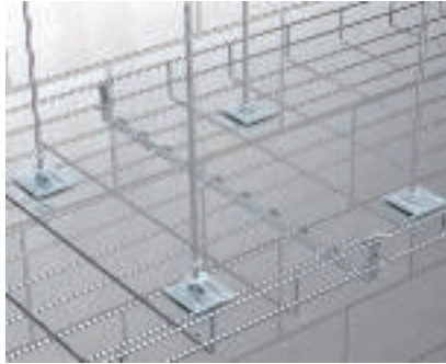
Dupla függesztés Rácsos kábeltálca felfüggesztése 2078 típusú menetes rúddal és K12 1818 típusú fali és padló rögzítővel. Alkalmazás 300 mm szélességtől.
