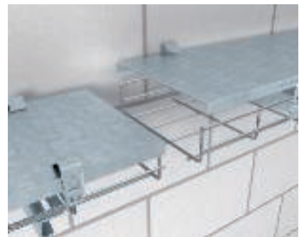
Fedélszerelés Rácsos kábeltálca felfüggesztése DRLU típusú fedéllel. A fedélnek a rácsos kábeltálca keresztvonalára való rögzítése DKU típusú fedélrögzítő-kapoccsal történik.
