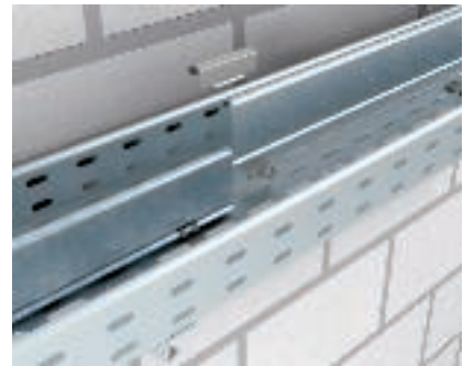
Válaszfal szerelése csavar nélkül A TSG ... válaszfal csavarok nélküli szerelése a KS KR szorítókapoccsal. A válaszfal egyszerűen a toldáspont fölé helyezhető, és a TSGV válaszfal-összekötő segítségével csavarok nélkül rögzíthető.
